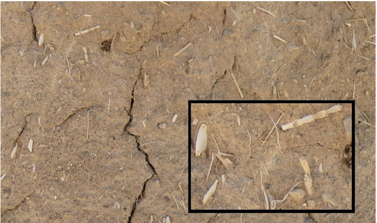
Fig. 2 : Exemple de terre à bâtir actuelle avec la balle utilisée comme dégraissante. La terre à bâtir de Shillourokambos a une densité de balle beaucoup plus importante. Le carré en bas à droite est une partie agrandie qui montre des glumes, les rachis et les barbes de blé.
