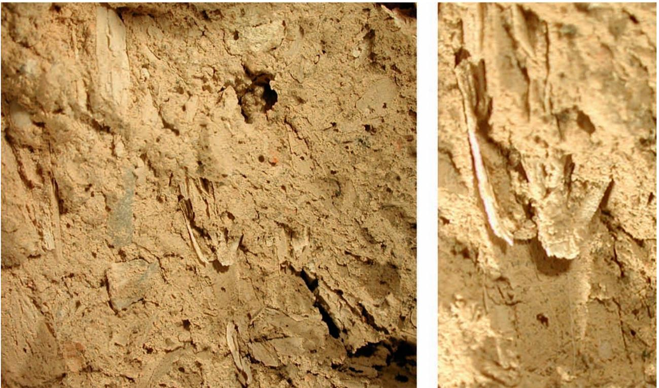
Fig. 3 : La terre à bâtir carbonatée de Shillourokambos, avec une base d'épillets d'amidonniér minéralisée.
